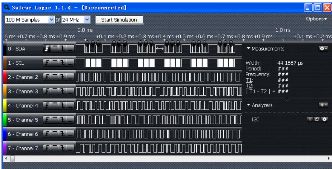
使用鼠标的滑轮，向上可以放大波形；向下可以缩小波形；
