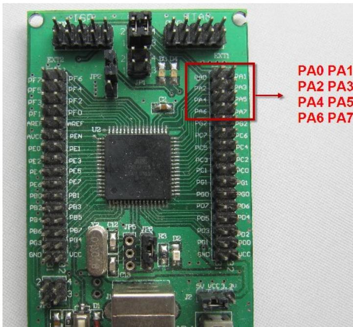
如上图右上部分，按照接口的 CH0-CH7 对应 PA0—PA7 接好后检查一下对应关系，
