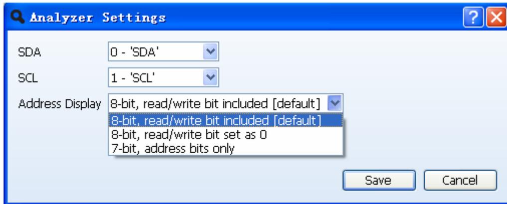
选取默认设置，SDA信号模拟在通道0，SCL信号模拟在通道1，地址显示设置选用默认的。
