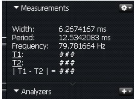
上图中 T1 T2 是 2 个水平标尺 选取后可以设置 T1 的水平位置 和 T2 的水平位置，可以方便的测试 2 个脉冲边沿的间距宽度。如下图所示。
